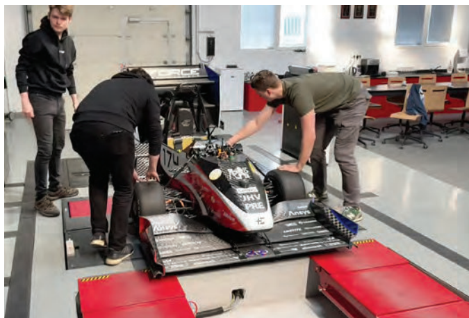
2 Výhoda zapuštěného zvedáku Hunter – snadné najíždění vozidel i s nízkou světlou výškou.
