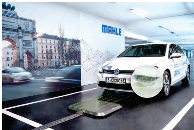
25 Společnost Mahle vyvinula polohovací systém pro indukční nabíjení, který umožňuje umístění elektrického vozidla přesně nad nabíjecí cívku v zemi.
