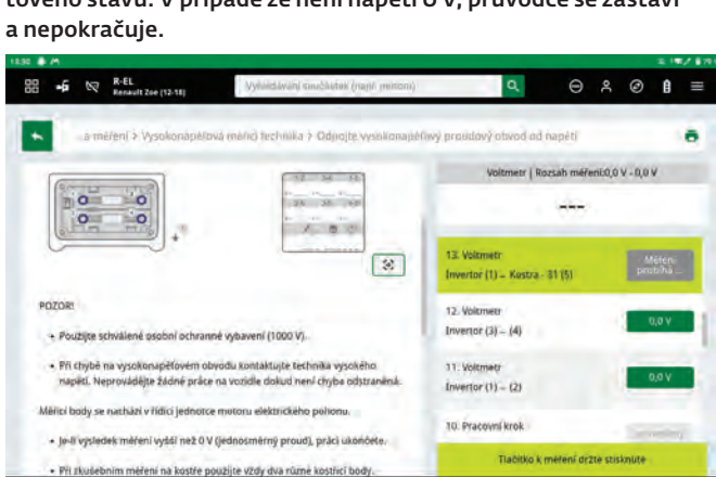
19 A teď samotné měření mezi měřicími body navzájem a také kostrou. V případě, že je naměřeno vyšší napětí, podržte tlačítko a dojde k vybíjení až na 0 V. Po proměření všech bodů vrátíte kryt, ověřte stejně jako na začátku měřící kabely a po správném označení máte hotovo.
