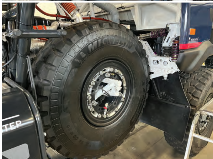
10 Rezervní kola našla nově místo za kabinou. Přesunutí dvou 130kilových hmot blíže těžišti přispívá k lepšímu rozložení hmotnosti. ←
