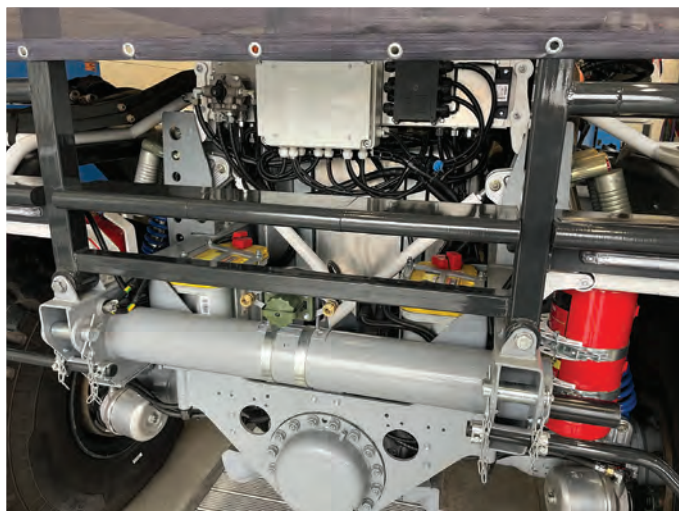
6 Detail zadní části vozu. Trubka tvořící příčník rámu představuje nejen pevnostní prvek, ale poslouží i jako schránka pro klíč na kola.
