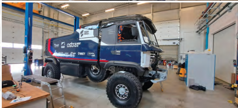
10 Rezervní kola našla nově místo za kabinou. Přesunutí dvou 130kilových hmot blíže těžišti přispívá k lepšímu rozložení hmotnosti. ←
