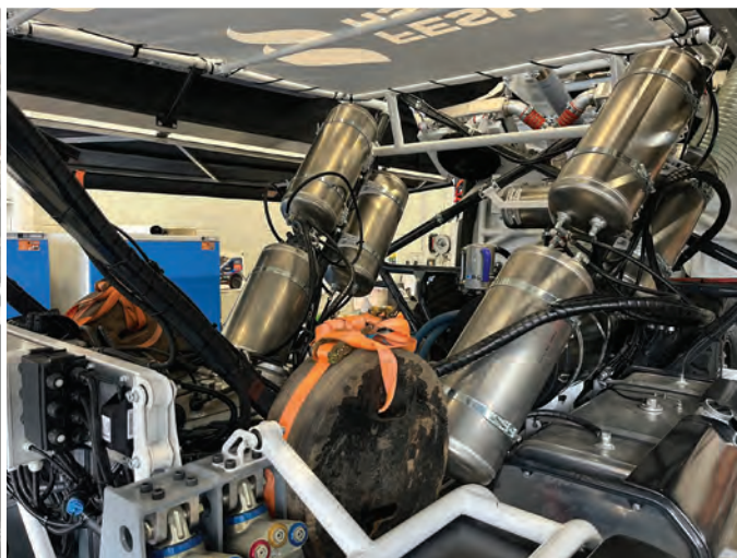
7 Vzduchojemy jsou rozmístěné na ochranném rámu nástavby.
