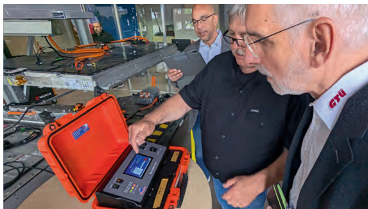
5 Společnost vyvinula svůj vlastní diagnostický nástroj pro zjišťování stavu akumulátorů.
