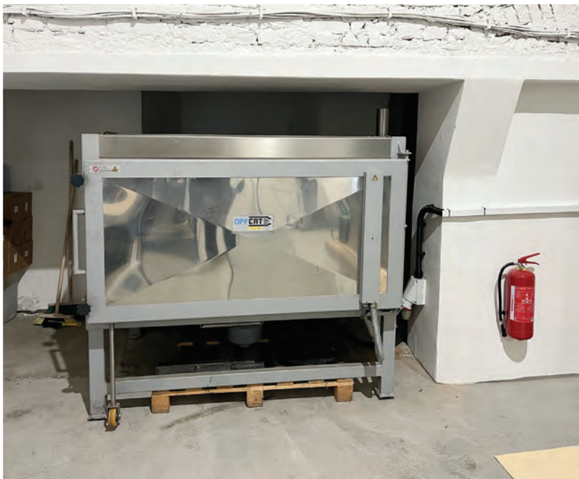
8 Keramická pec na sušení filtrů. Právě proces sušení je velmi důležitý a subjekty nabízející službu čištění DPF jej často podceňují.
