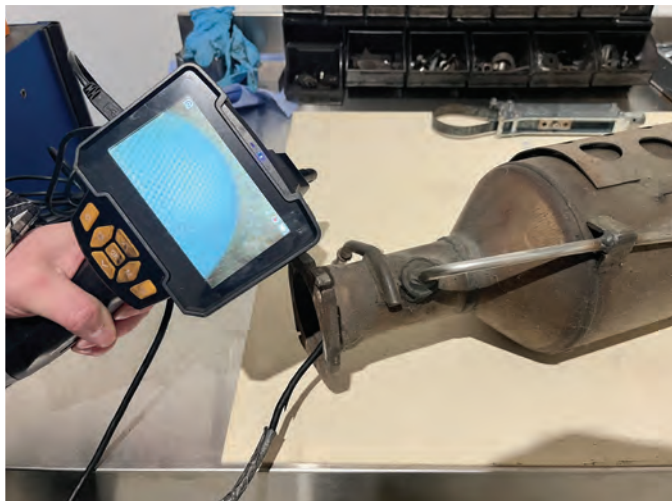
9 Před samotným čištěním probíhá vždy vizuální kontrola keramického těla filtru endoskopem. Jakékoliv mechanické poškození jej vyřazuje ze hry.
