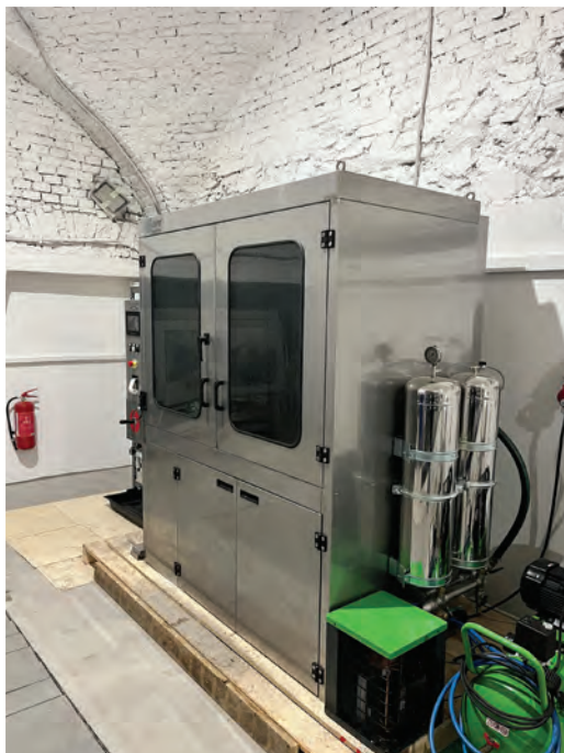
7 Stroj pro mokré čištění v kombinaci s velkým objemem vzduchu a tlakovými pulzy.
