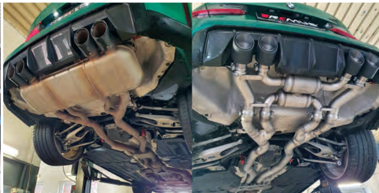
4 Srovnání originálního a high performance výfukového systému Remus.
