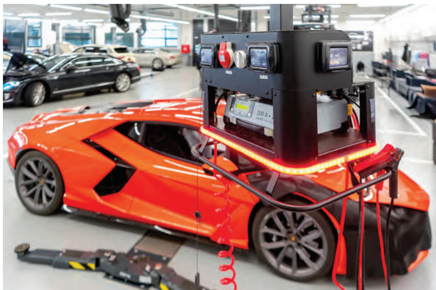
5 Energy hnízda PowerLab integrují přívody energií, stlačeného vzduchu, datového připojení a nabíječku akumulátorů.
