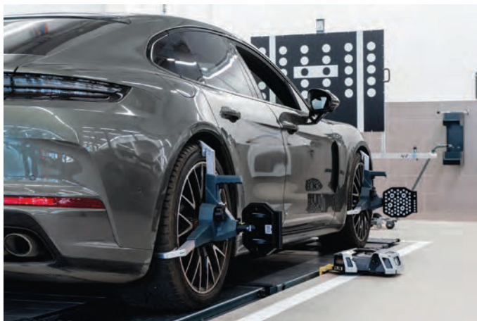
6 Pracoviště pro kontrolu a seřízení geometrie je vybaveno zařízením nejnovější generace.
