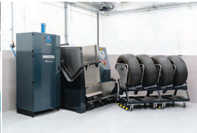
9 Automatická myčka kol Drester GP24 Le Mans dokáže samostatně umýt celou sadu kol vložených do speciálního vozíku.
