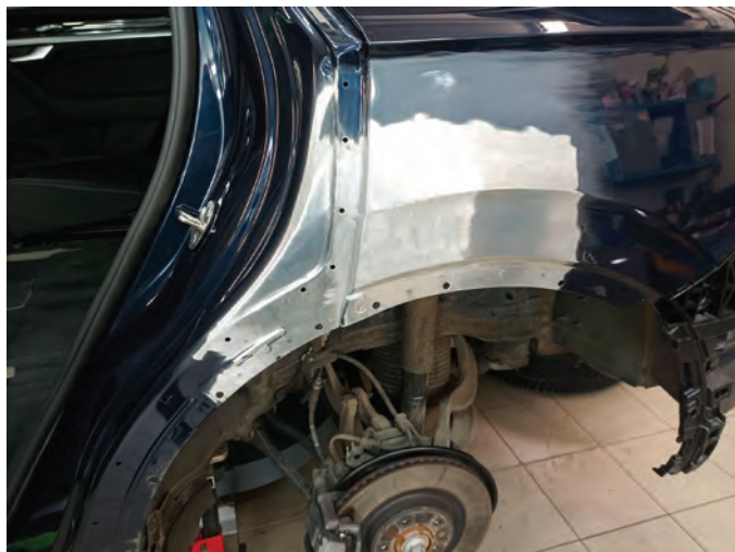
14 Vzhled poškozené hliníkové části vozidla po opravě.
