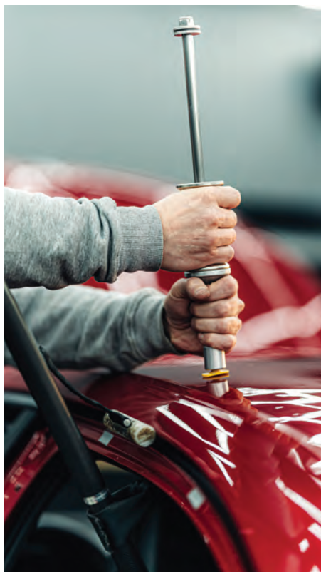
4 Jeden ze základních způsobů metody PDR – vytahování promáčkliny z vnější strany.
