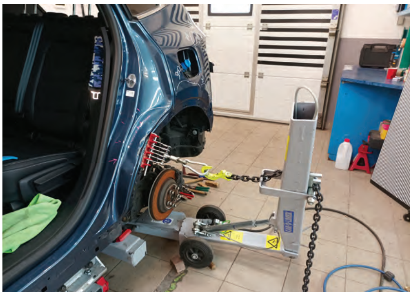
7 V základní výbavě zde najdete také karosářský zvedák Car-O-Liner Speed, který disponuje tažným ramenem pro tahání panelů karoserie nebo pro tahání menších strukturálních poškození.
