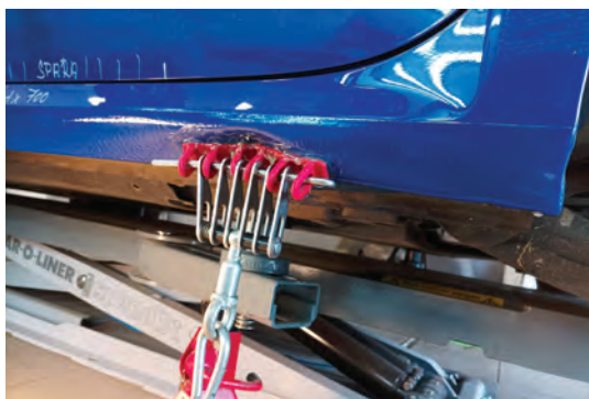
10 Oprava lepicí metodou a vytahováním.
