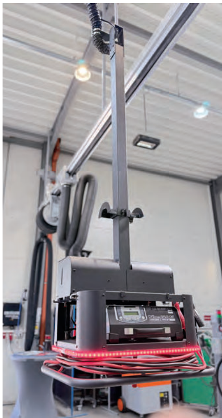
6 Teleskopické energetické hnízdo s vloženou nabíječkou akumulátorů.
