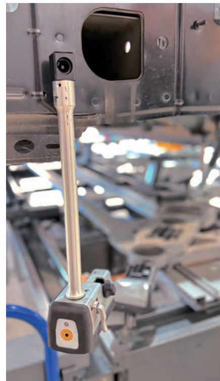
3 Integrované měření karoserie Car-O-Tronic v systému rovnací stolice Car-O-Liner.
