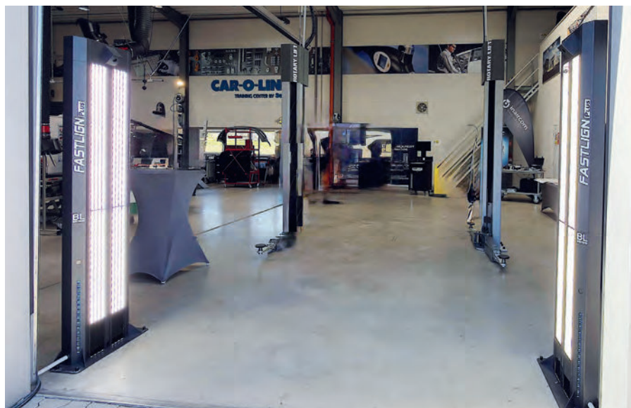
1 Detekční rám Fastlign Plus společnosti BL Innovare, umístěný přímo ve vjezdu do karosářského centra.
