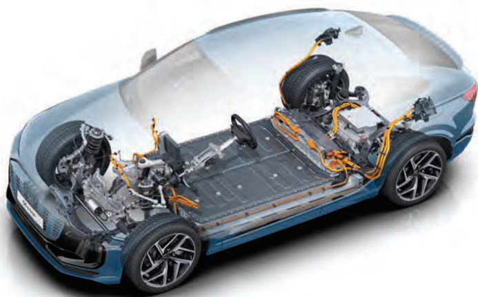
3 Umístění vlastního akumulátoru ve vozidle, zde v případě Audi Q6 Sportback e-tron.
