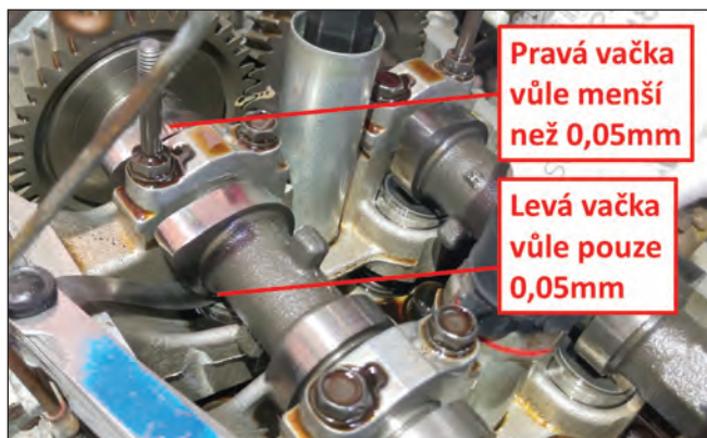
1 Změřená vůle levého výfukového ventilu válce č. 1 byla 0,05 mm.
