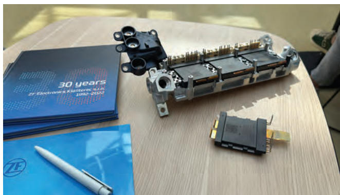
3 Nová generace výkonové elektroniky využívá polovodiče z karbidu křemíku (SiC).
