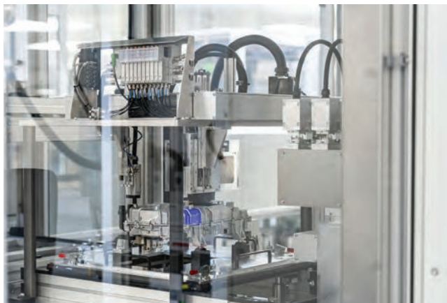
13 Závěrečné automatické testování ověřuje správnou funkci celého kompletu.
