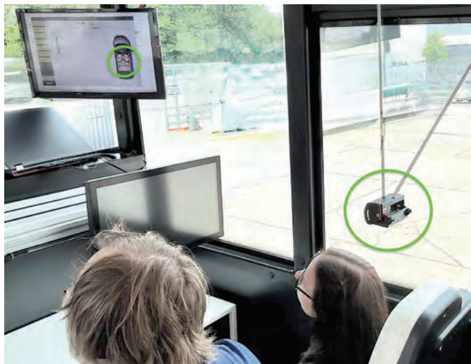
10 Předvedení interiérového radaru (kroužek vpravo), na monitoru je vidět detekce osob (kroužek vlevo).
