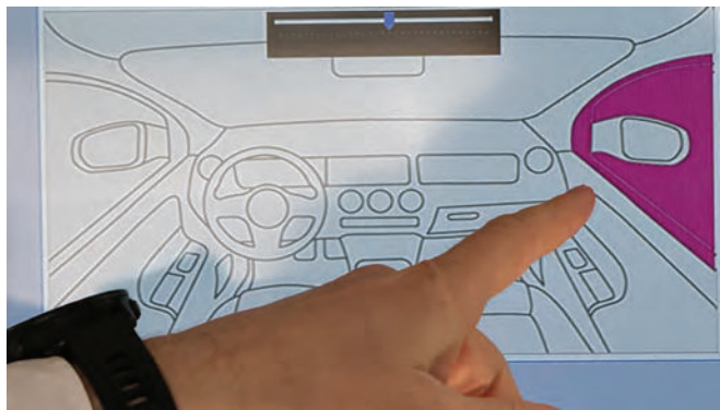
11 Ukázka detekce oblasti pomocí interiérové kamery, kam směřuje pohled řidiče.
