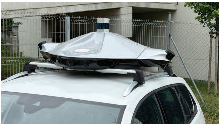
9 Referenční měřicí platforma REJ vytváří přesný obraz okolí vozidla (ground truth), který slouží k ověřování kamer, radarů a lidarů.
