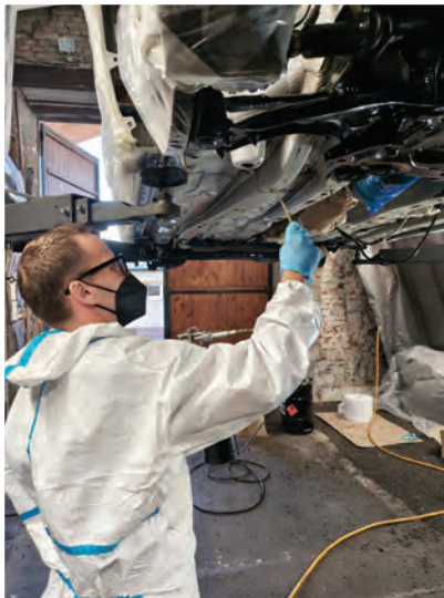
7 a 8 Po ošetření rezavých míst materiálem Dinitrol RC900 následuje ošetření spojů, přepřátování a dutin materiálem Dinitrol ML (tzv. penetrace).
