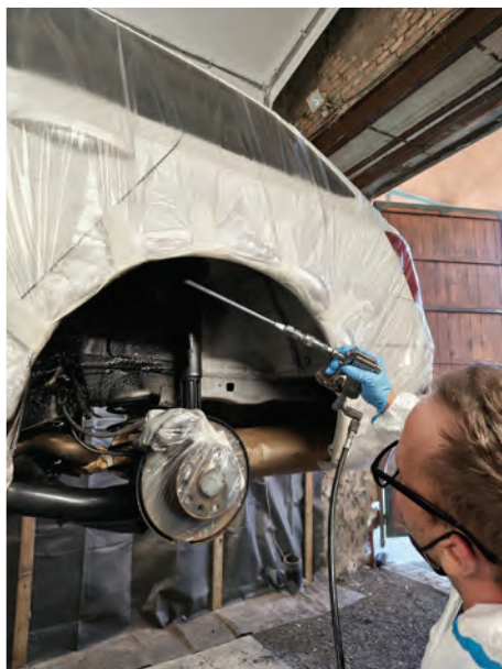
9 Následuje vlastní aplikace ochranného nástřiku. V tomto případě je to Dinitrol 4941.
