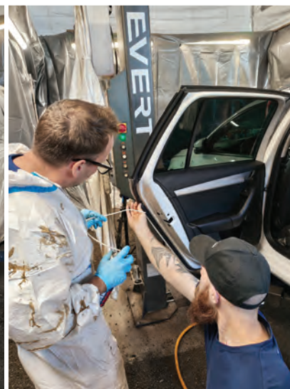
12 a 13 Po ukončení práce na spodku se vozidlo částečně odmaskuje a ostatní dutiny se ošetří podle aplikačního schématu (manuálu) voskem Dinitrol 1000.
