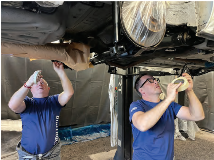
6 Po základním zakrytí karoserie a brzd je třeba ještě páskou a papírem zakrýt konektory, výfuk atd. Pečlivé maskování velmi přispívá k celkovému zpracování zakázky.
