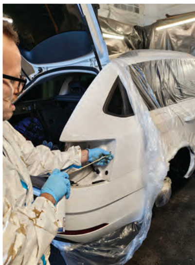
12 a 13 Po ukončení práce na spodku se vozidlo částečně odmaskuje a ostatní dutiny se ošetří podle aplikačního schématu (manuálu) voskem Dinitrol 1000.
