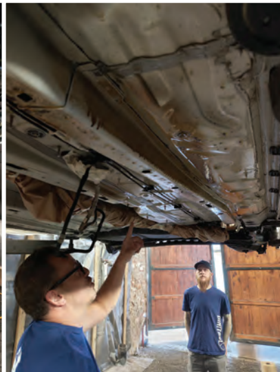
7 a 8 Po ošetření rezavých míst materiálem Dinitrol RC900 následuje ošetření spojů, přepřátování a dutin materiálem Dinitrol ML (tzv. penetrace).
