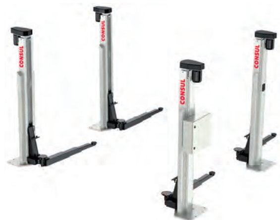
5 Čtyři samostatné sloupy zvedáku Consul C-Line Wohnwagen používají otočná podpěrná ramena a elektronicky synchronizované pohony. Rozestavení lze přizpůsobit vozidlu.
