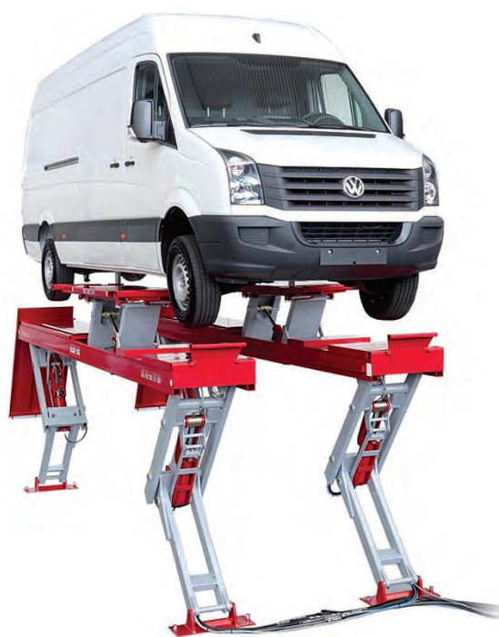
6 Výrobce OMER u systému KAR používá pantografický mechanismus. Model KAR 55 má navíc jako jediný plošinový zvedák integrovaný prahový přízved s teleskopickým prodloužením více než tři metry. Na takovém přízvedu lze zdvihnout i celou dodávku.
