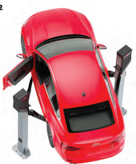
1 a 2 Zvedáky řady Comfort Line výrobce Consul mají sloupky pootočené o 30 stupňů a vzájemně posunuty. Výsledkem je větší úhel otevření dveří bez nutnosti zvětšovat šířku pracoviště.
