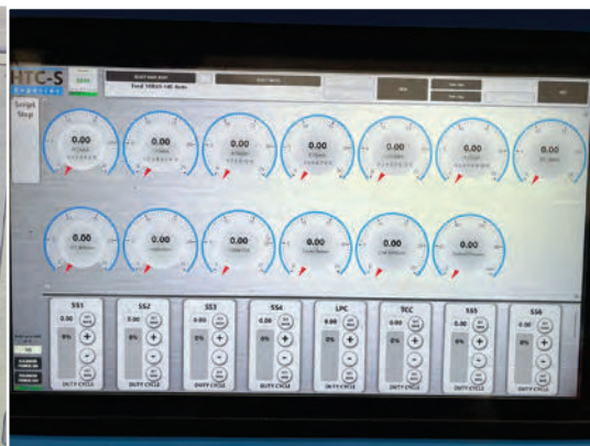
10 Ukázka testovaných parametrů. U automatických převodovek je klíčovou veličinou tlak hydraulické kapaliny.
