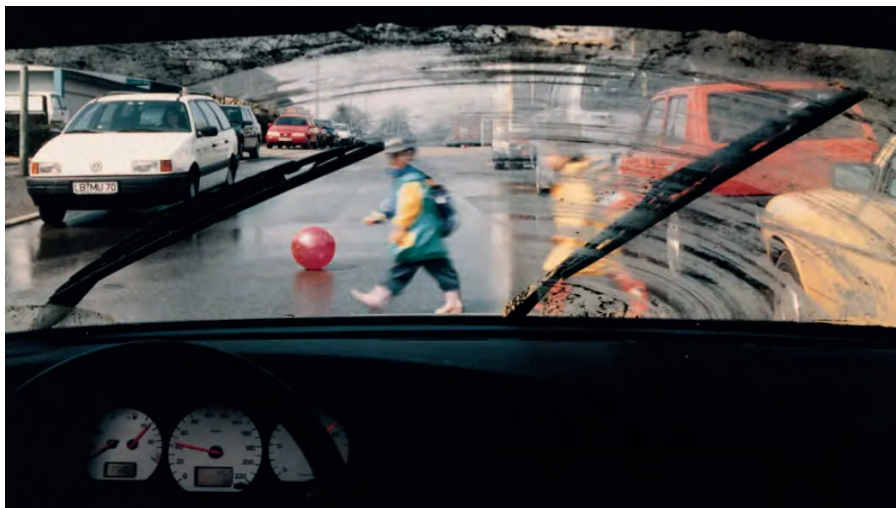
5 Porovnání modelu Twin (vlevo) s konvenční stírací lištou (vpravo).
